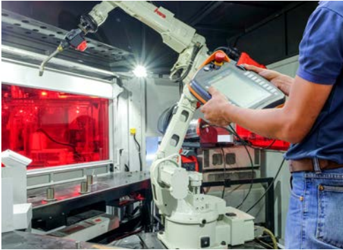
Mit 5G drahtlos gesteuerter Schweißroboter.
